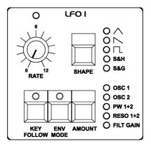
Gehen Sie bei unseren nächsten Experimenten bitte wieder vom Grundklang aus oder von einer Abwandlung, die Sie bereits vorgenommen haben. Lokalisieren Sie den Regler RATE im grafisch abgetrennten Bereich LFO 1. Ihm ist eine LED zugeordnet, die die Geschwindigkeit des LFOs sowie seine Schwingungsform darstellt. Drehen Sie RATE und beobachten Sie, wie die LED ihren Blinktakt gemäß ihrer Bewegung verändert.
